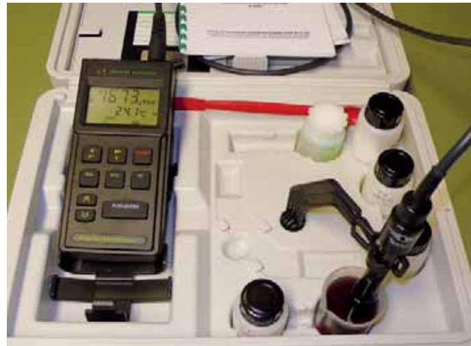
Abb. 6: Krista-Test-Konduktometer zur Bestimmung der Weinsteinsättigungstemperatur
