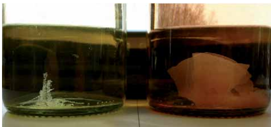
Abb. 5: Ausfall von Weinstein nach dem Kältetest in Weiß- und Roséwein
